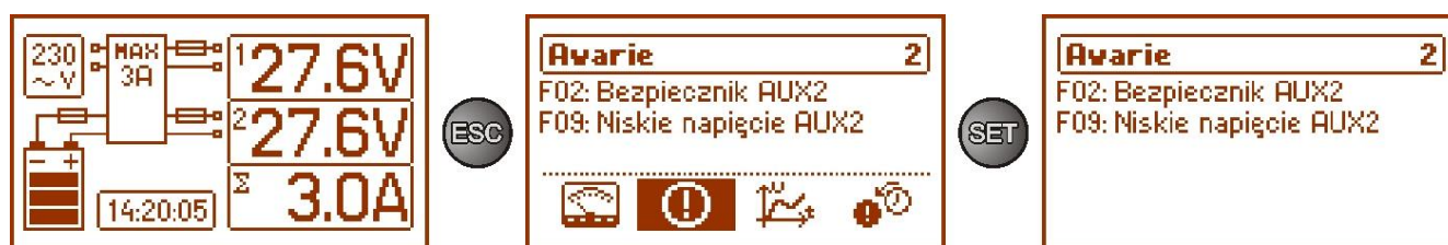
Rys. 12. Ekran – bieżące awarie zasilacza.
