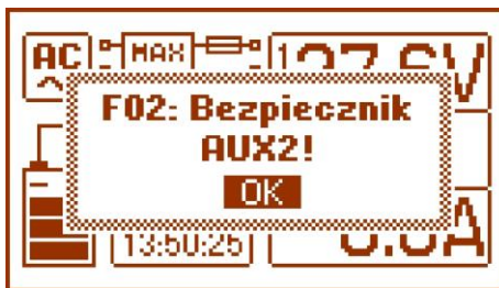
Rys. 11. Komunikat sygnalizujący przepalenie bezpiecznika na wyjściu AUX2.
