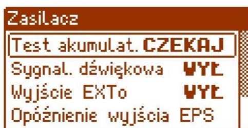
Rys. 27. Czasowe zablokowanie testu akumulatorów.
