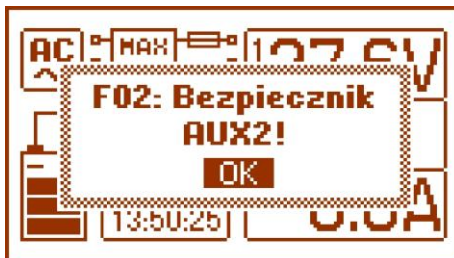
Rys. 11. Komunikat sygnalizujący przepalenie bezpiecznika na wyjściu AUX2.
