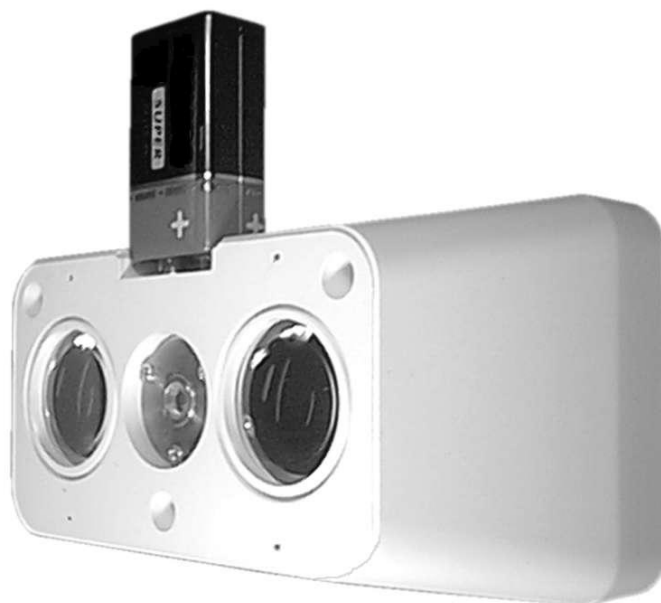
Rys 2. Czujka DOP-6001R podczas zestrainia toru optycznego
